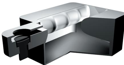
Votre SUP F-ONE est équipé de la SMART HANDLE qui intègre la vis de décompression. La vis peut se visser et dévisser à l'aide de l'outil multifonction qui se loge également dans la poignée. Un joint en caoutchouc garantit l'étanchéité lorsque la vis est vissée au maximum. Lorsque vous dévissez, quelques tours suffisent à laisser passer l'air grâce à la gorge prévue dans le filetage de la vis. Inutile d'enlever la vis intégralement.
