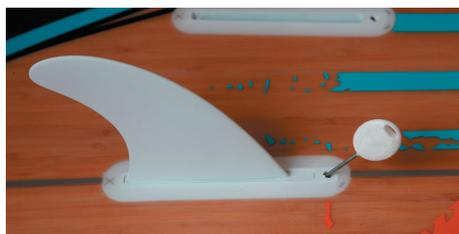
Les dérives latérales sont asymétriques. Attention de bien les monter avec la face «bombée» vers l'extérieur du SUP (face creuse vers l'intérieur du SUP).
