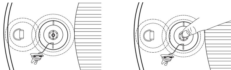
**Au centre de la valve se trouve une tige qui commande l'ouverture et la fermeture de la valve. Pour ouvrir la valve, appuyez dessus et tournez d'un quart de tour pour la verrouiller en position ouverte.** Pour fermer la valve, tournez d'un quart de tour dans l'autre sens et laissez la tige ressortir en partie.
