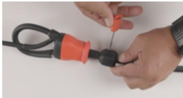
2. Dévisser la vis de maintien du Quick Release au niveau du dévireleur.
