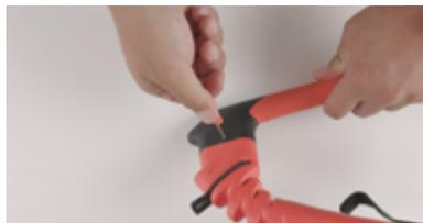
1. Dévisser la vis du flotteur à l'aide de la clef fourni dans le sac de la barre.
