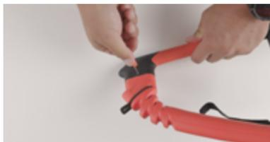
1. Dévisser la vis sur le flotteur en utilisant le tool fourni dans le sac.
